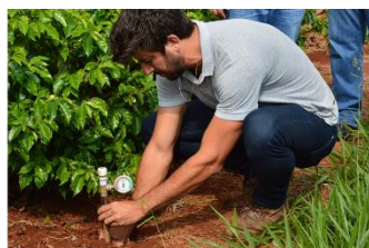
Uso de tensiômetro para estabelecer tensão do solo
